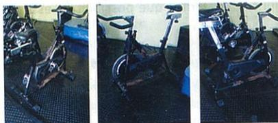
Existem 2 tipos de spinning, a de pressão magnética e de pressão mecânica que é a mais comum em academias, em ambas a manutenção é semelhante, o que difere é a limpeza do sistema magnético, que deve ser limpo com querosene branco e secar com pano seco, e do sistema de monitoramento por computador que deve ser limpo com silicone em aerosol e secar com uma flanela seca.
